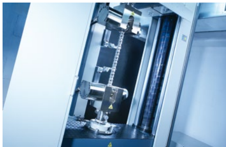
Zincir kopma dayanımının ve 1000 kN'ye kadar esnemenin değerlendirilmesi Evaluation of chain breaking strength and elongation up to 1000 kN
