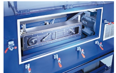
Zincir yıpranma uzaması davranışının test edilmesi 20'den fazla test platformunda yapılır Testing of chain wear elongation behaviour on more than 20 test rigs
