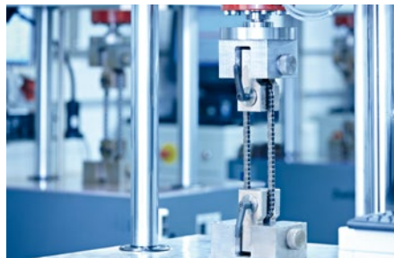
Farklı test yöntemlerine göre dinamik yorgunluk dayanımı testleri için 15'den fazla pulser mevcuttur More than 15 pulser are available for testing dynamic fatigue strength according to different testing methods
