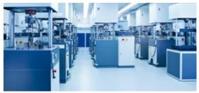
Es stehen mehr als **21 Impulsgeber** (weltweit) zur Prüfung der dynamischen Dauerfestigkeit anhand verschiedener Testmethoden zur Verfügung
