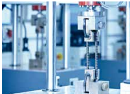
可以利用超过25个脉冲发生器根据不同的测试方法测试动态疲劳强度
