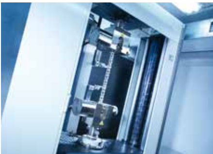
评估在高达1000 kN时的链条断裂强度和伸长率
